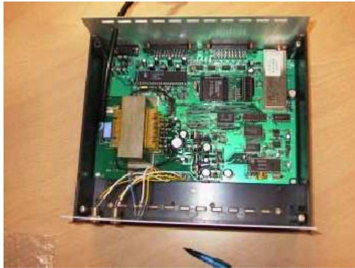
Figura 2.3: Prototipo de *Set-Top-Box*
